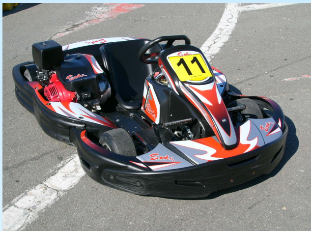
Châssis SODIKART avec moteur 4 temps HONDA de 390 cc
